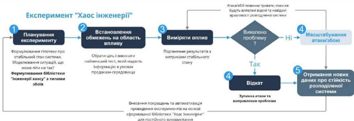
Рис. 1 – Етапи створення експерименту в методології «Інженерія хаосу» для тестування стійкості розподілених систем
