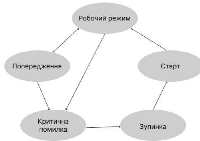
Рис. 1. Граф переходів станів автоматної діагностичної системи
