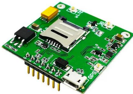
Рис 7 – Плата SIMcom SIM7600E-H
