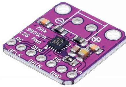
Рис. 3 – Звукова плата MAX98357
