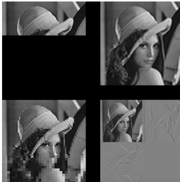
Рисунок 1 – Послідовність обробки Baseline JPEG, Progressive JPEG, дискретним косинусним перетворенням, вейвлет-перетворенням
