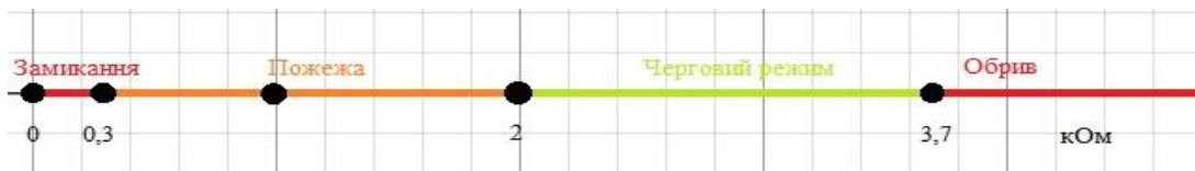
Рис. 8. Номограма режимів ППКП при роботі зі сповіщувачами з контактами, які замикаються без верифікації за двома сповіщувачами
