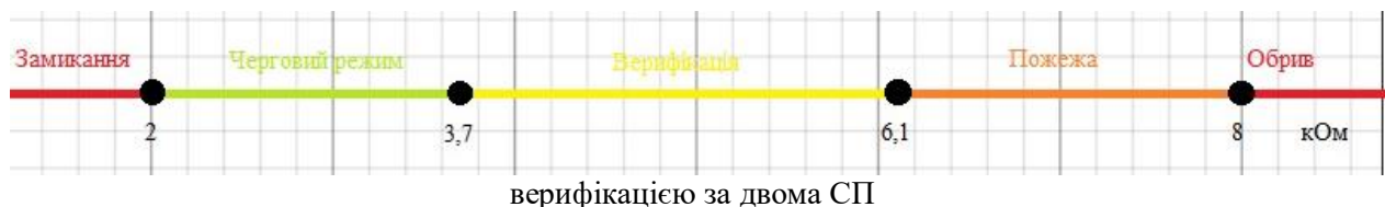
Рис. 2.9. Номограма режимів ППКП при роботі зі сповіщувачами з контактами, які розмикаються та
