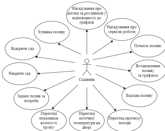
Рис. 2 – Діаграма вимог, яка описує функціональні можливості підсистем догляду за присадибною ділянкою та садом в інформаційній системі «Розумна садиба»
