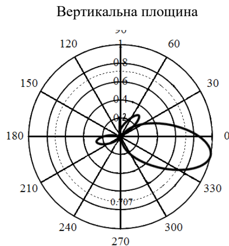
Рис. 9. Діаграма направленості синфазної антенної решітки.
