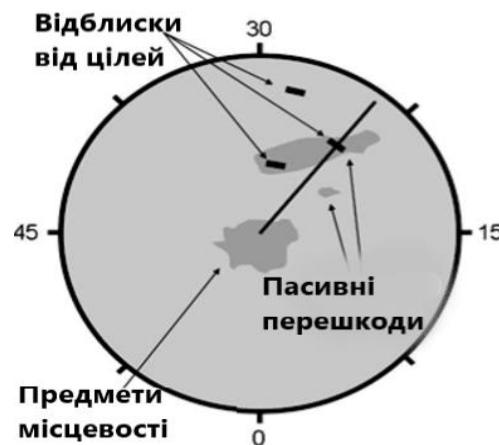
Рисунок 3 – Вид пасивної перешкоди на екрані ПП після її компенсації
