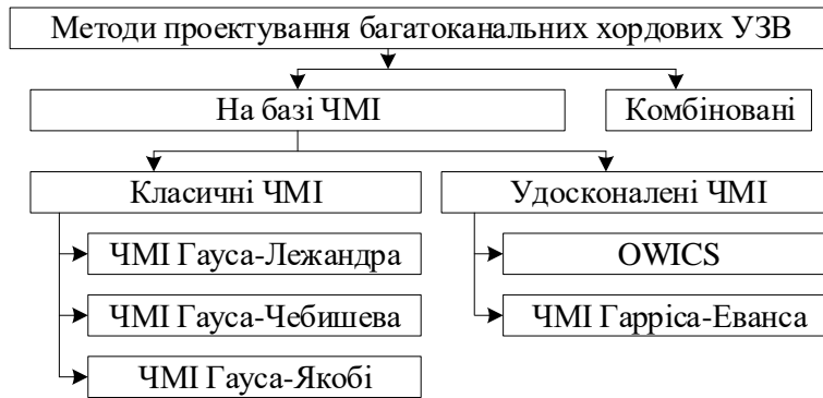
Рисунок 2 – Класифікація методів проектування багатоканальних хордових УЗВ
