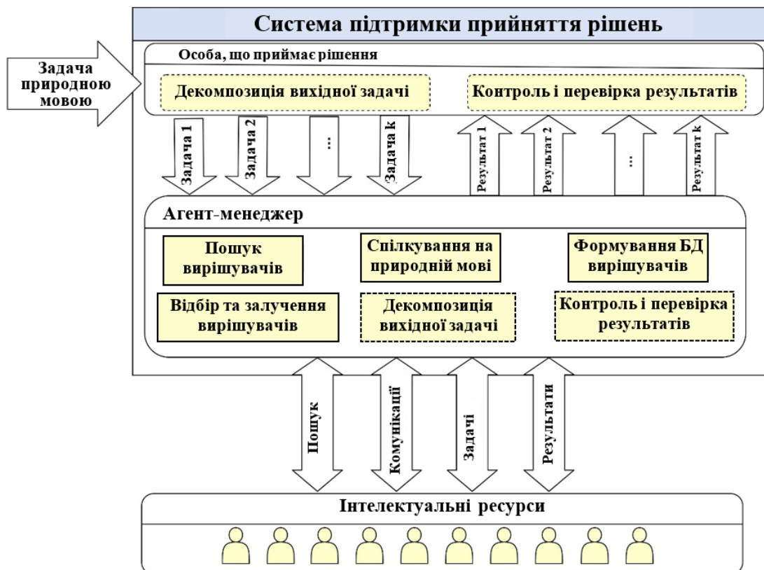
Рисунок 1 – Система прийняття рішень з використанням агента-менеджера та інтелектуальних вирішувачів (експертів) [31-34]
