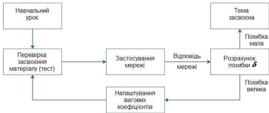
Рисунок 2 – Загальна схема навчання з використанням процедури зворотного поширення
