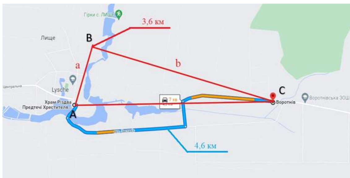
Рисунок 1 – Різниця між відстанню за формулою гаверсинуса та реально пройденою
