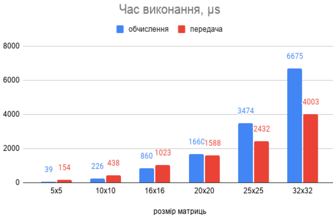
Рис. 4. Тестування виконання операцій матричного множення для цілочисельних 4-байтних даних на платі ESP8266.
