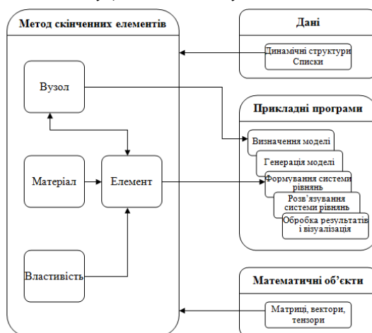
Рис. 2. Структура об'єктно-орієнтованої програми методу скінченних елементів
