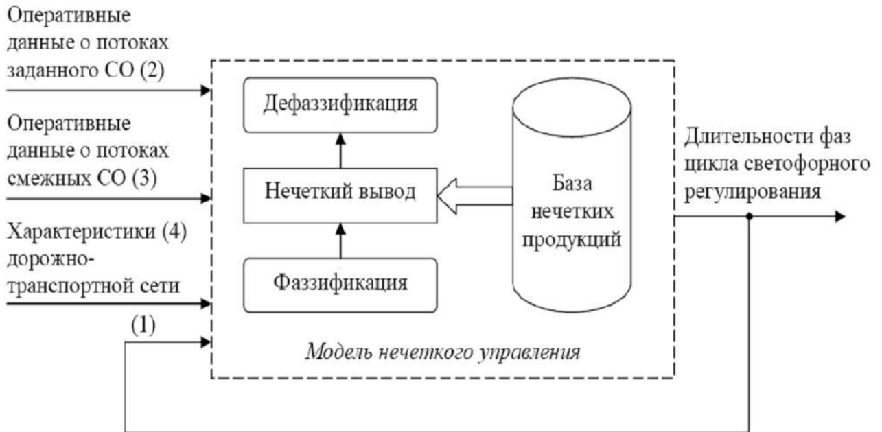
Рис. 6. Структура модели нечеткого управления светофорным регулированием на заданном светофорном объекте
