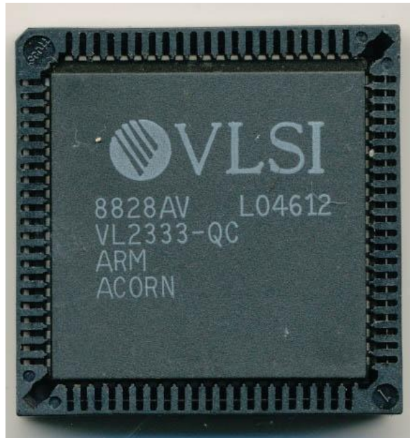
Рис. 2. Чіп ARM1 - первісток компанії Acorn Computers, який проводився на фабриках VLSI
