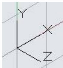
Рис. 2. Система координат після обертання навколо осі X
