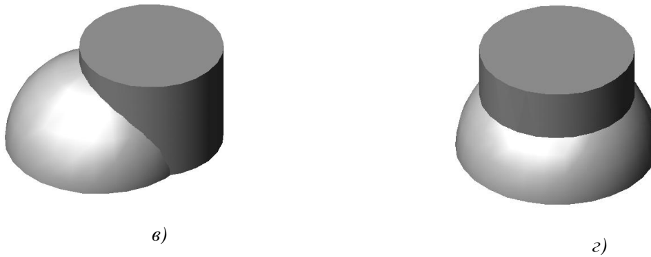
Рис.1. Взаємний перетин поверхонь сфери та циліндра [авторська розробка]
