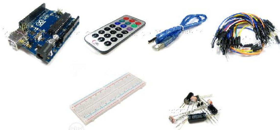
Рис. 2. Електронні компоненти для макетування ІЧ-давача
