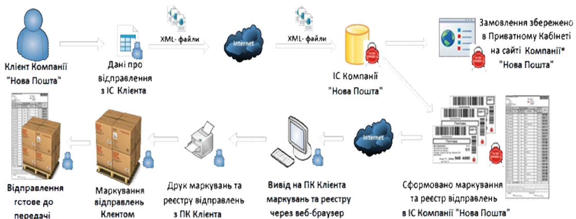
Рис. 1. Схема обміну даними між інформаційними системами різних підприємств
