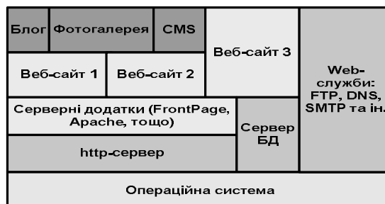
Рис.1. Структура програмного забезпечення веб-сервера
