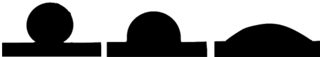
Рис. 2. Типові обриси краплі із хорошим змочуванням на протязі експерименту
