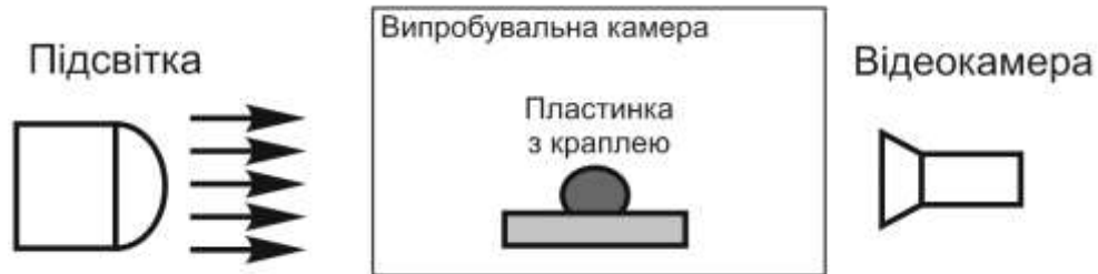
Рис. 1. Схема експериментального визначення кінетики змочування
