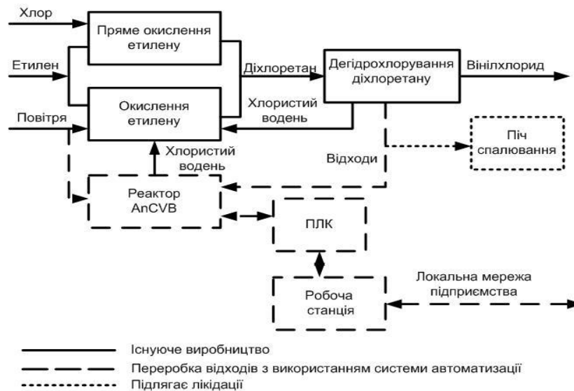
Рис. 1. Структурна схема модернізованої системи виробництва вінілхлориду
