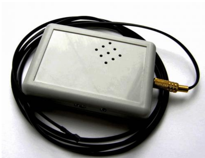
Рис. 1. Балакучий термометр "Градус — 05"
