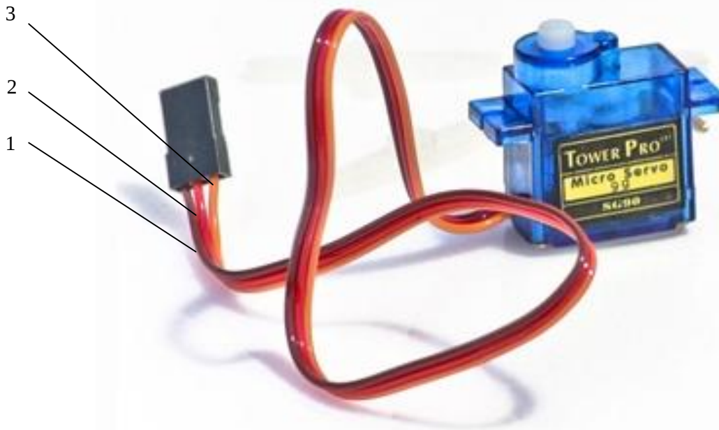
Рис. 3. Сервопривід Tower Pro 9g SG90: 1 – коричневий провід — земля (Ground, підключається до піну GND на платі Arduino); 2 – червоний провід — живлення +5V (підключається до піну 5V на платі Arduino); 3 – жовтий провід — сигнал керування (підключаємо до цифрового піну Arduino)[8].
