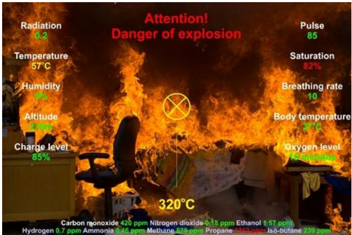
Рисунок. 5. Поле зору пожежника з показниками сенсорів які накладаються на зображення реального світу
