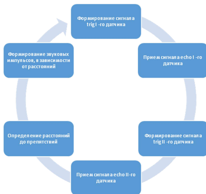
Рисунок 1 – Алгоритм работы микроконтроллера с двумя сенсорами
