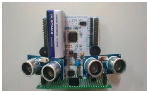
Рисунок 3 – Макет сенсора с двумя ультразвуковыми датчиками
