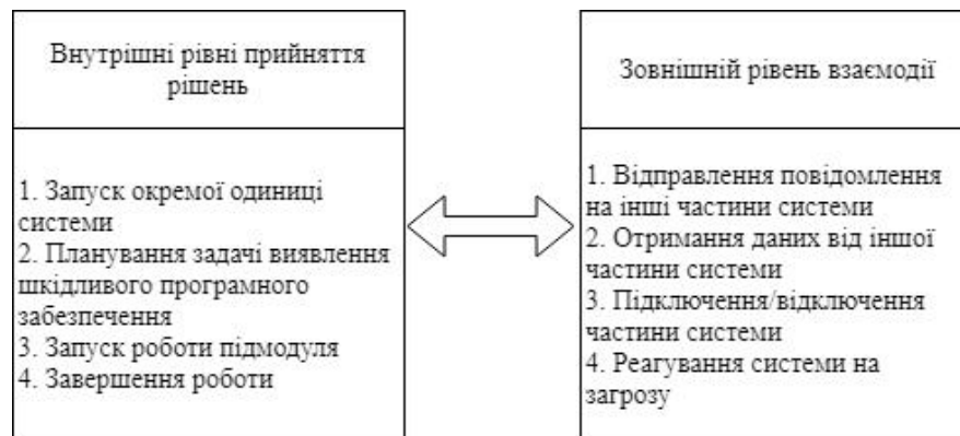
Рис.3. Схема взаємодії внутрішнього та зовнішнього рівнів
