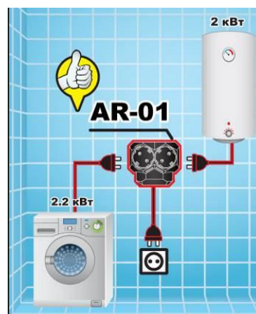
Рис. 3. Автоматичний регулятор навантаження мережі «AR-01»: а – зовнішній вигляд; б – варіант підключення [12]
