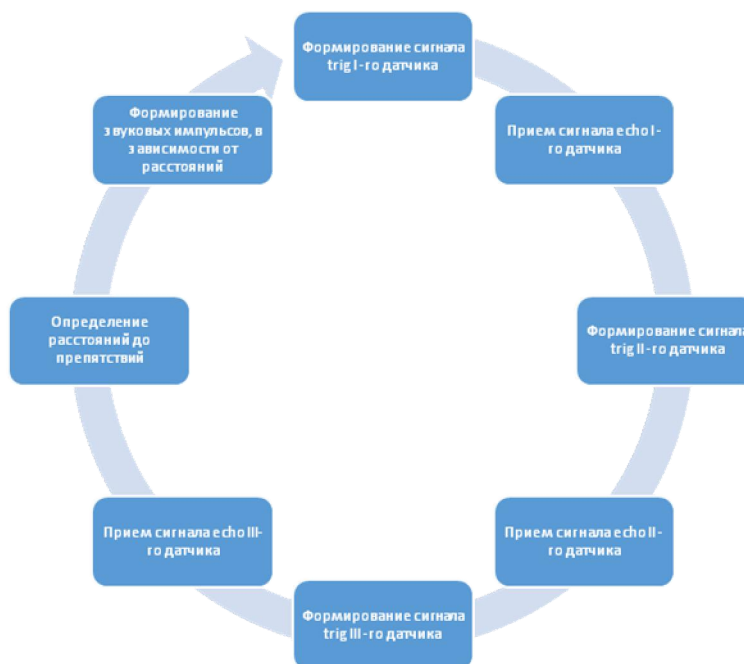
Рисунок 4 – Алгоритм работы микроконтроллера с тремя сенсорами
