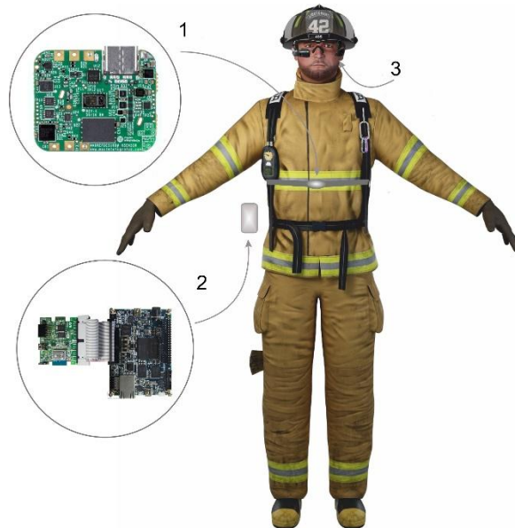
Рисунок. 1. Блок-схема системи телеметрії з елементами доповненої реальності. 1 - модуль спостереження за фізіологічним станом, 2 – модуль аналізу оточення, 3 – окуляри доповненої реальності Intel/Recon Jet Pro
