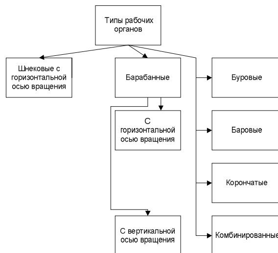
Рис. 5 – Классификационная схема угледобывающих комбайнов по типам рабочих органов
