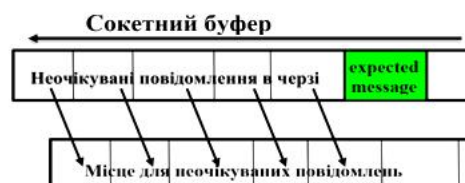
Рис. 1. Залежність ефективності тримання очікуваного повідомлення від попередніх в черзі та неочікуваних повідомлень
