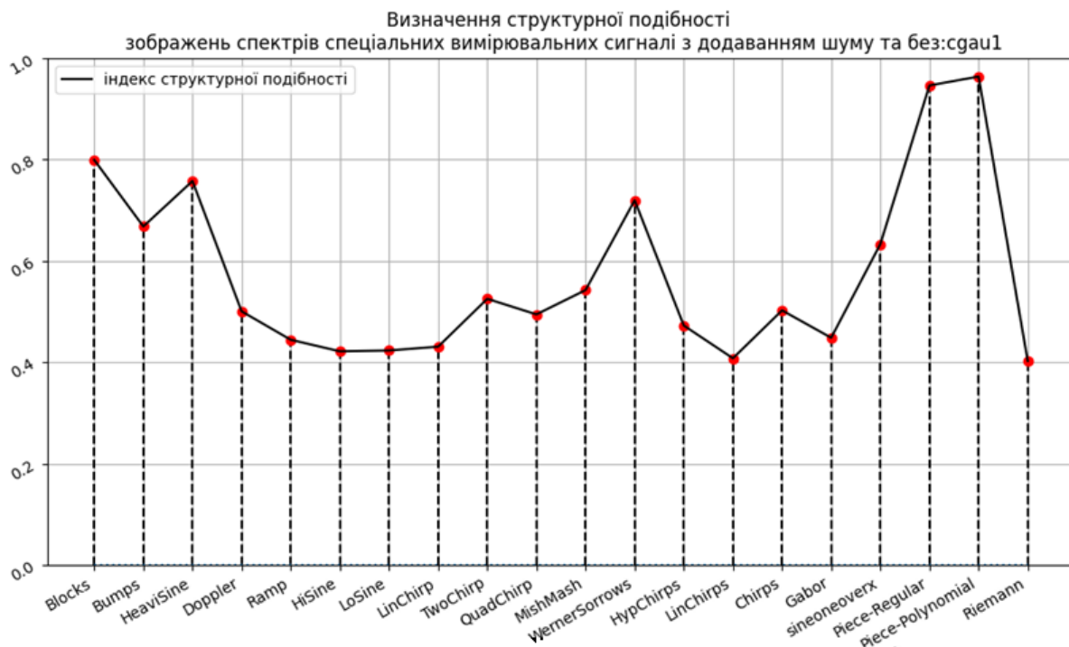
Рис. 13. Визначення структурної подібності зображень вейвлет-спектрів спеціальних сигналів
