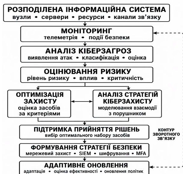
Рис. 1. Архітектура системи підтримки прийняття рішень для вибору засобів захисту інформації
