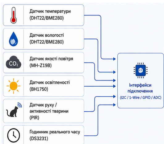
Рис. 2 Сенсорний блок збору даних мікроклімату
