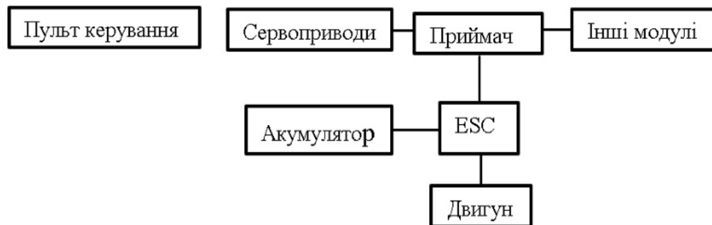
Рис. 7 – Типова схема електрична структурна БНА
