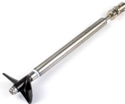
Рис. 13 –Зовнішній вигляд дейдвуда
