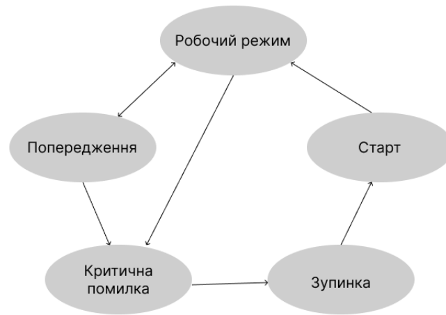
Рис. 1. Граф переходів станів автоматної діагностичної системи
