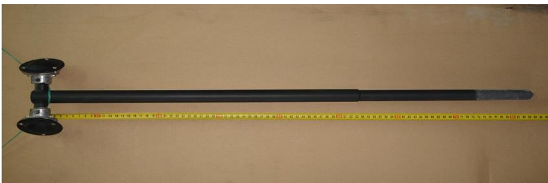
Рис.1. Пристрій контролю теплового режиму горна і циклів "накопичення-випуск"
