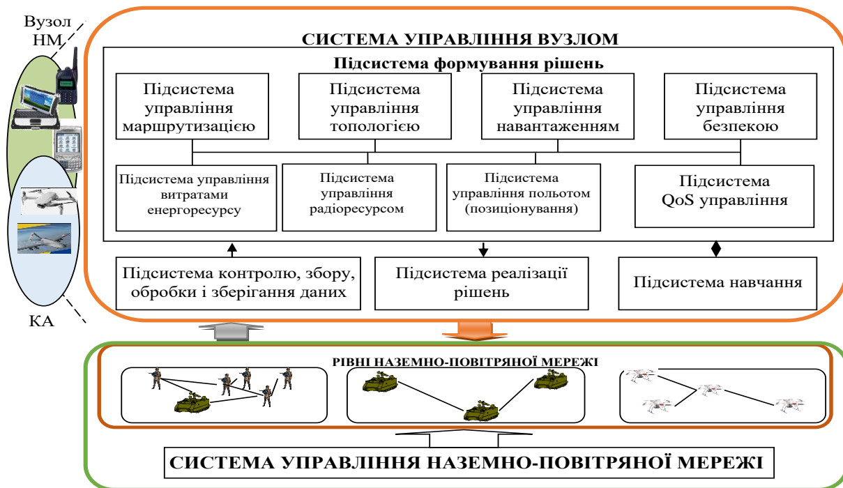
Рис. 1 – Система управління комунікаційними вузлами НІМ
